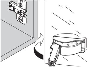
2. Scharnier in die Montageplatte einclipen
