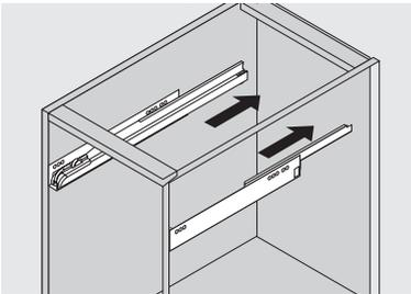
2. Schub einsetzen und nach hinten schieben
