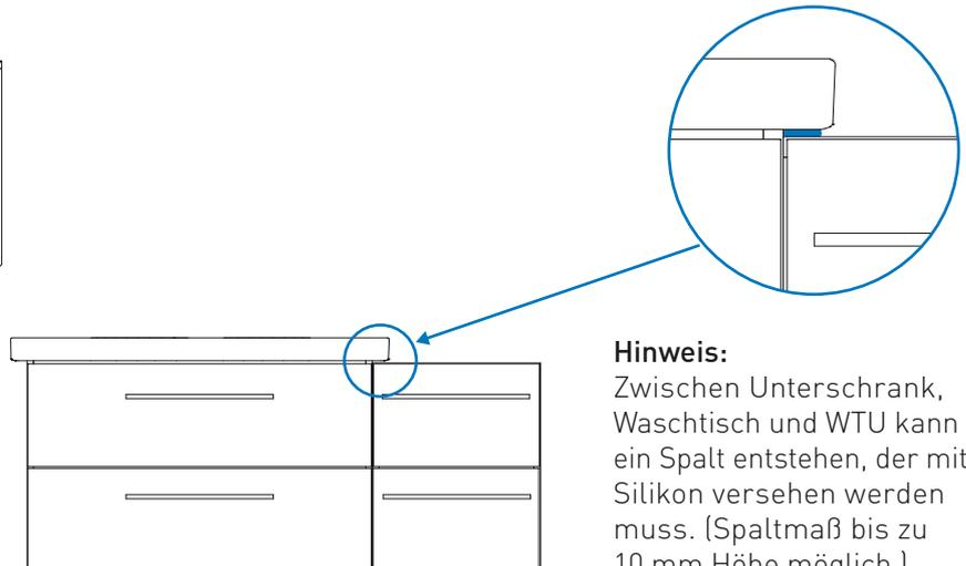
**Hinweis:** Zwischen Unterschrank, Waschtisch und WTU kann ein Spalt entstehen, der mit Silikon versehen werden muss. (Spaltmaß bis zu 10 mm Höhe möglich.)
